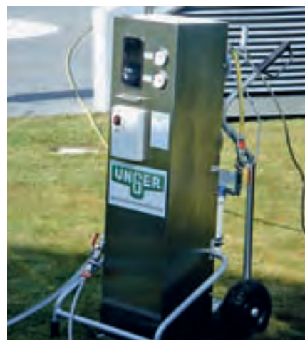
Das Osmose-Gerät filtert das Wasser und schützt so vor Wiederverschmutzung.
